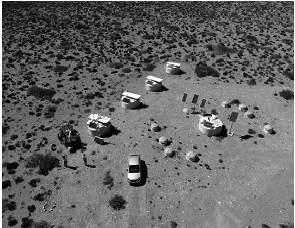
Figura 3: Vista aérea de una zona con detectores de superficie y tubos de inspección para los centelladores del UMD (instrumentación del proyecto de mejora del Observatorio), enterrados a 2,5 metros de profundidad. Nótese la recuperación de la flora local, lenta pero evidente, un tema que es parte de la planificación para la instalación de detectores del Observatorio. Fuente: Observatorio Pierre Auger.
