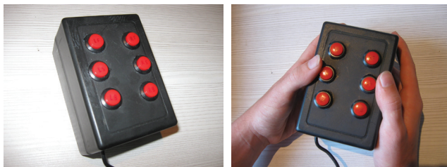
Figuras 5 y 6. Hardware con pulsadores manuales distribuidos de modo similar a la ubicación de los altavoces que rodearon a los participantes.
