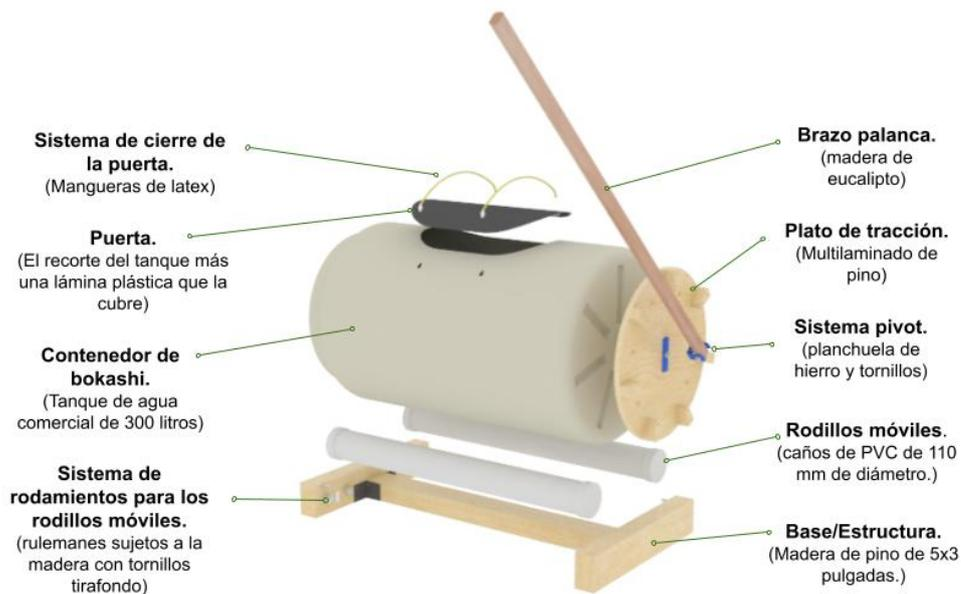
Figura 3. Diseño del dispositivo con los elementos que lo componen.
