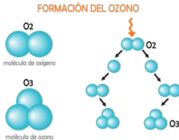
Figura 4. Proceso en dos pasos para formar ozono en una cámara de plasma sobre la base de inyección de oxígeno molecular ambiente. A la izquierda se ilustran moléculas de oxígeno y de ozono.
