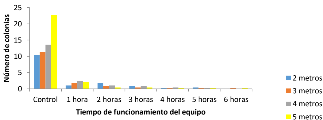
Figura 6: Número promedio de colonias fúngicas, a través del tiempo, tomadas a una distancia que va desde los 2 metros hasta los 5 metros de distancia del prototipo. El equipo no tenía las luces UV-C encendidas, solo trabajaba en la función de filtrado.
