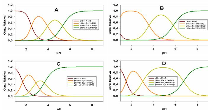
Figura 3. Funciones de distribución simuladas para sistemas conteniendo 0.15 mM de Fe(III) y 1 mM de los diferentes ligandos: (A) 2HBA, (B) 24dHBA, (C) 2H4NBA, (D) 2H5NBA.
