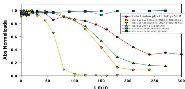
Figura 4. Perfiles cinéticos de degradación del complejo Fe(2H5NBA) para diferentes valores de pHs y en ausencia de irradiación. Condiciones: [Fe(III)]=0.15mM, [Ac.] =1mM.
