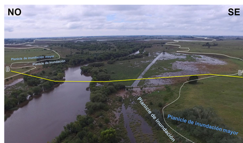
Figura 8. Imagen aérea del sitio 2 desde el puente Correas en el mes de agosto de 2024, luego de intensas precipitaciones. La línea punteada blanca representa el límite entre unidades geomorfológicas. La línea continua amarilla representa la transecta sitio 2.
