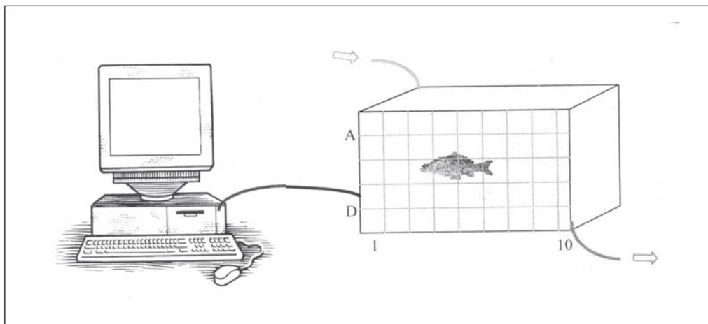
**Figura 1.** Esquema del dispositivo utilizado en los experimentos de este trabajo. Las flechas indican la dirección de los flujos de soluciones; A corresponde a la franja superficial y D a la más profunda; 1 es la sección en la que gotea las soluciones y 10 es la más alejada del sitio de goteo.
