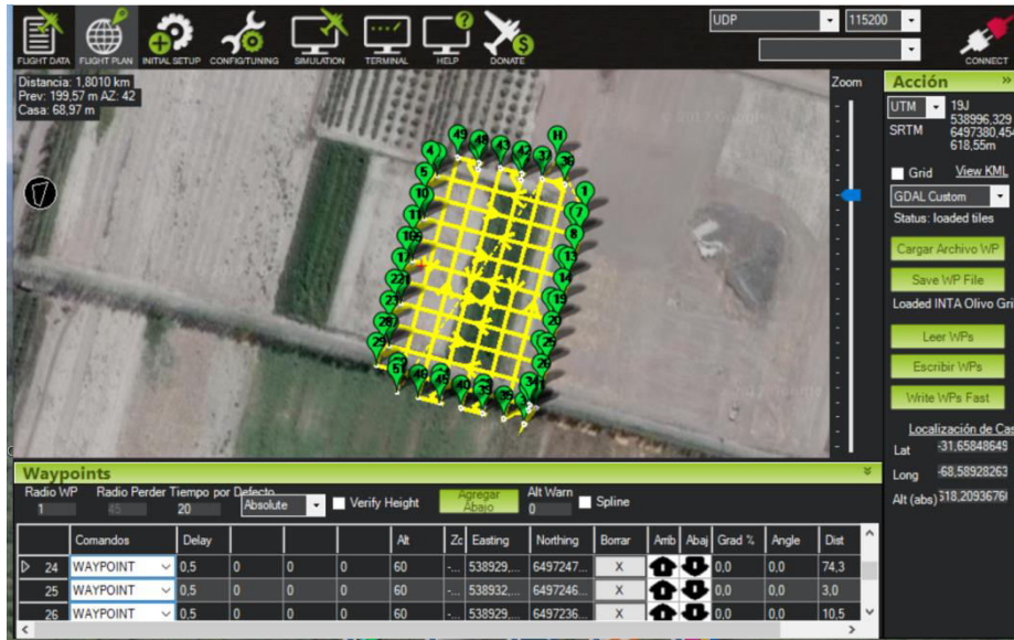
Fig. 5. Planificación de la trayectoria de vuelo (tipo grilla) utilizada para la adquisición de las imágenes del olivar de estudio.
