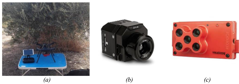
Fig. 3. Plataforma UAV y sensores utilizados para la adquisición de las imágenes: (a) UAV tipo cuatrirrotor 3DR Robotics Solo; (b) cámara termográfica FLIR Vue Pro-R 640; (c) cámara multispectral MicaSense RedEdge de 5 bandas.
