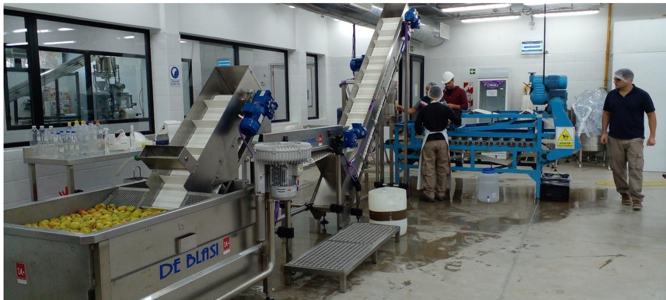
Figura 6. Planta piloto de elaboración de sidra de la UNRN, operaciones de molienda, prensado y obtención de jugo.
