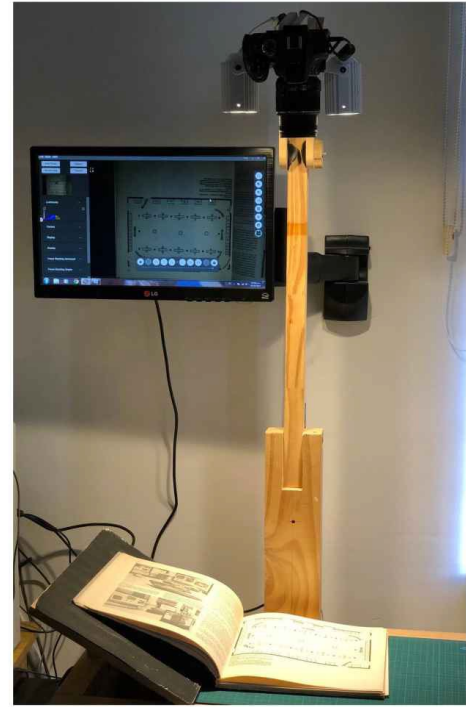
Figura 4. Escáner cenital. Fuente: elaboración propia.
