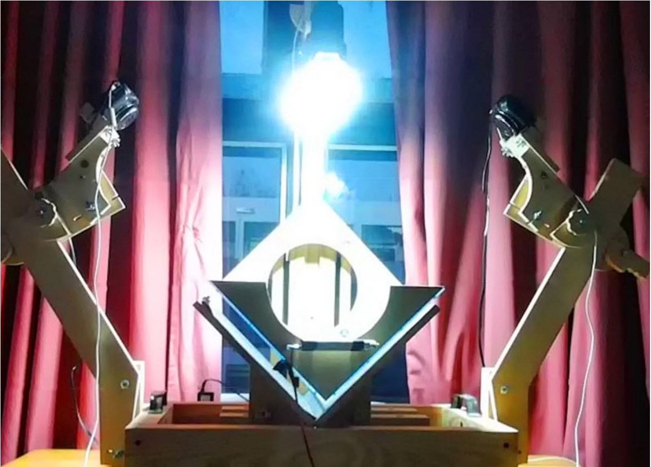
Figura 3. Primer escáner DAL de SEDICI basado en el Model 1 de DIY. Fuente: elaboración propia.
